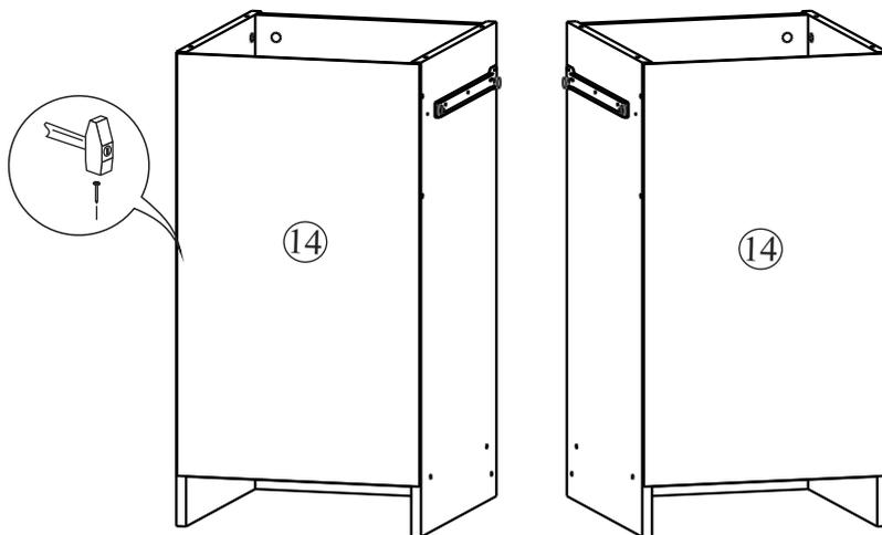
Монтаж эксцентриковой стяжки
